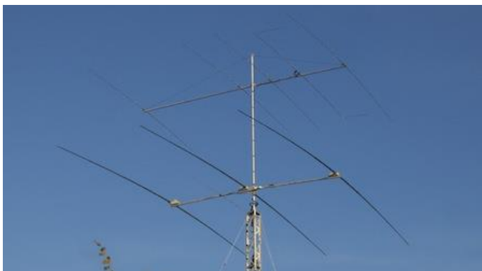
Figura 18 - Yagi de 3 elementos para 15m (monobanda) e yagi de 5 elementos (OPDES) para 6m mais acima no mastro. Note que o mastro gira e aponta as duas na mesma direção.
