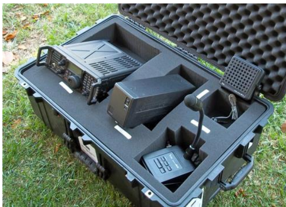
Figura 2 – Exemplo de uma estação simples: rádio e fonte. Faltam: a antena e acessórios na foto. (cortesia de K2BSA & ICOM Inc. – IC-7200, OS-126 & SM-50).
