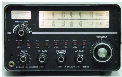
Figura 9 - Rádio receptor da marca Drake, modelo 2A. O dial tinha o indicador vertical que deslizava à medida que o botão grande, chamado de VFO ou (frequency) era movimentado.
