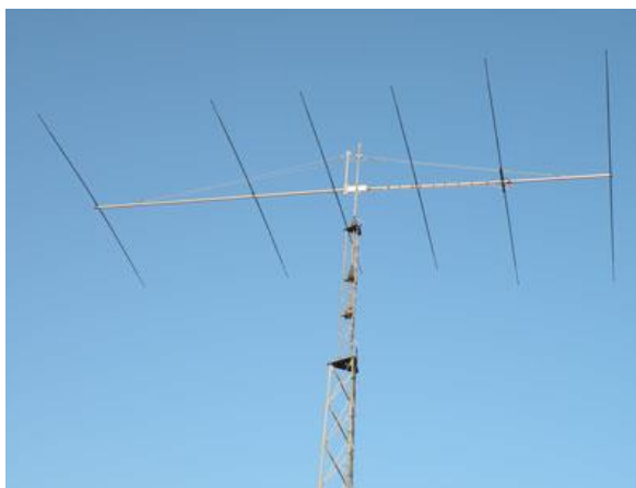
Figura 19 - Yagi de 6 elementos: quatro diretores e um refletor. O dipolo principal é o segundo, da direita para esquerda. Note o tamanho da “gondola” que sustenta os dipolos: 8m – dois veículos em linha
