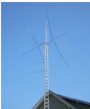
Figura 22 - Antena "Cubica de Quadro" com dois elementos. Porém pode-se verificar que em cada suporte em X, há cinco antenas (fios), portanto tratam-se de cinco cúbicas dividindo o mesmo sistema de sustentação.
