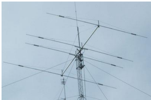
Figura 20 - Yagi encurtada e multibanda, para 10, 15 e 20m com 4 elementos. Podemos ver uma vertical no topo do mastro. As “bobinas” nos elementos tem múltiplas funções.
