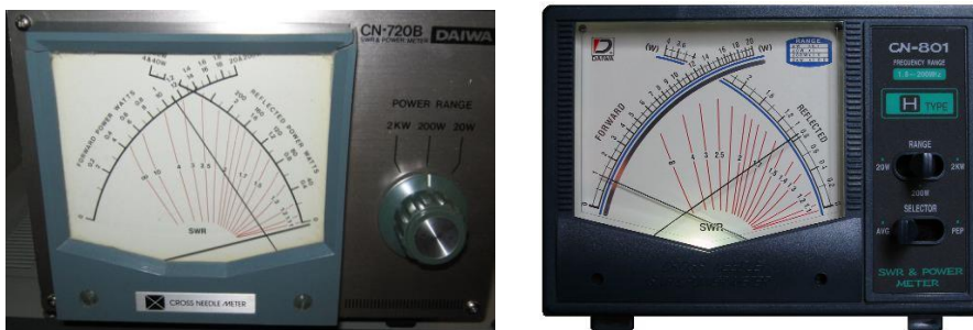
Figura 12 - Medidores de estaçãoária comercial, fabricados pela Daiwa Co. A escala esquerda mede a potência direta e a escala direita a potência refletida.
