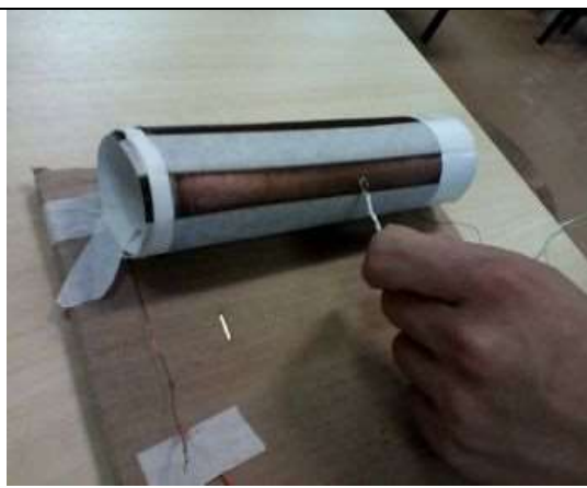
Figura 15b: Ajuste fino da sintonia
