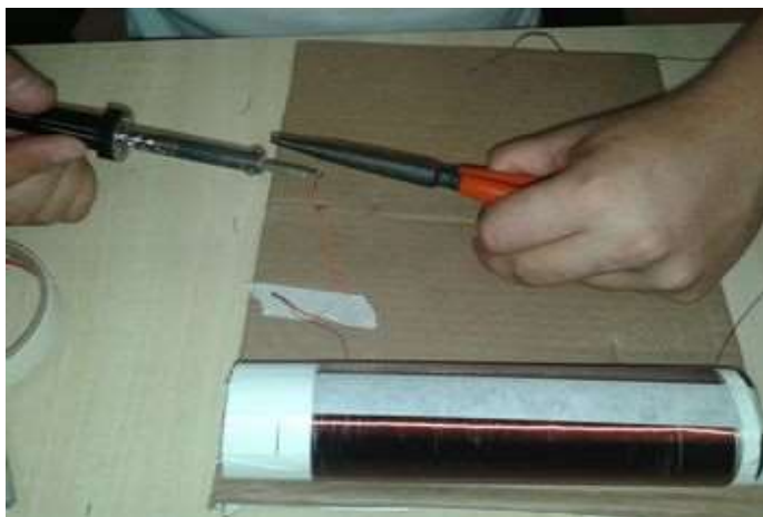
Figura 10a: Soldagem do diodo ao indutor
