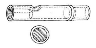
del cañuto. Luego se le talla una superficie plana como se muestra en la figura 4., para dejar un espacio entre la caña y el relleno para el paso del aire. Finalmente se coloca en la cavidad, cuidando que quede en la posición apropiada.
