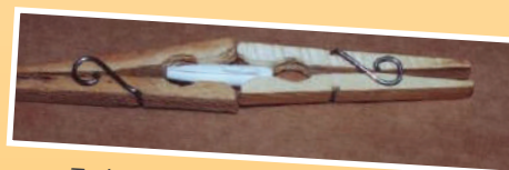
Turbina presa durante a secagem
