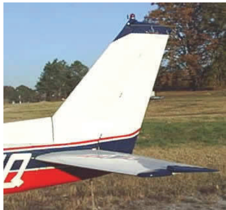
Asa horizontal (estabilizador e profundor) na cauda
