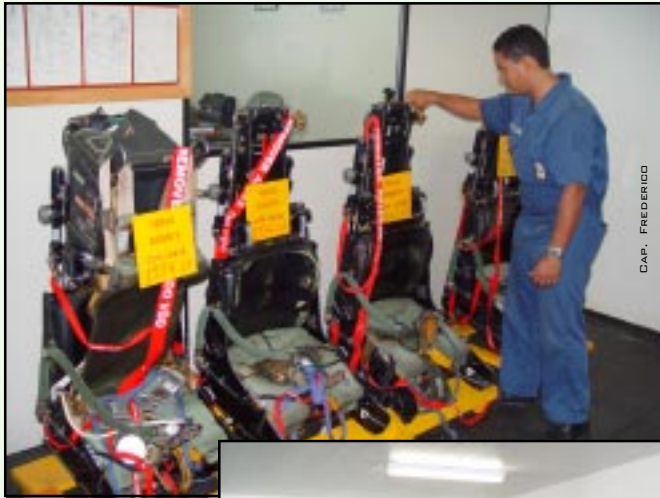
◀ O cuidado com a manutenção dos assentos ejetáveis
