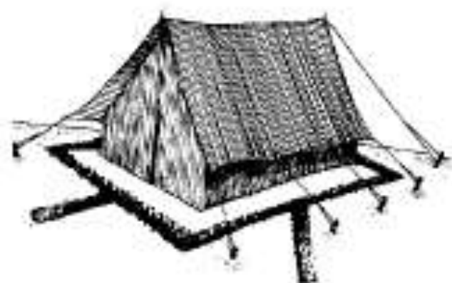
Ilustração 4 - Detalhe de barraca canadense com canais de drenagem ao seu redor
