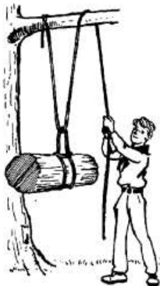
Ilustração 11 – Levantando-se um tronco com um sistema de "roldana móvel"
