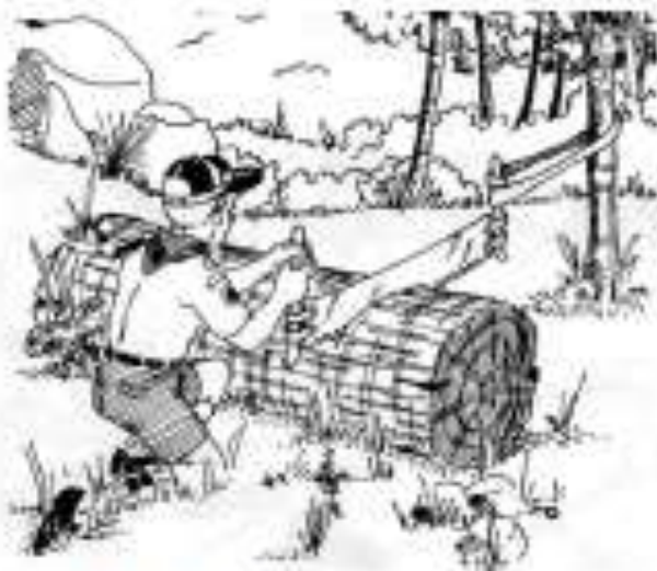
Ilustração 1 – Câmara de pneu ajudando o serrote a retomar
