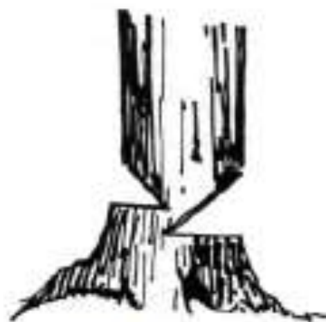
Ilustração 12 - Corte do lado oposto para se finalizar a derrubada da árvore
