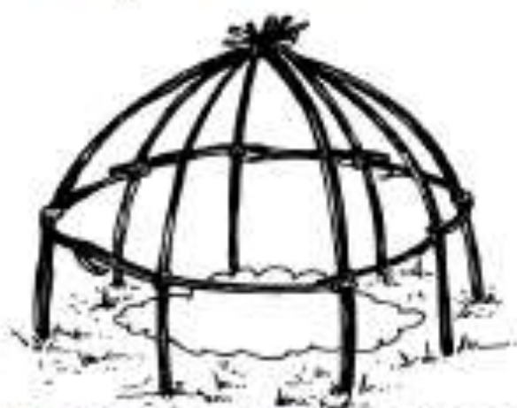
Ilustração 8 - Construção de armação de varas para cobertura com palha
