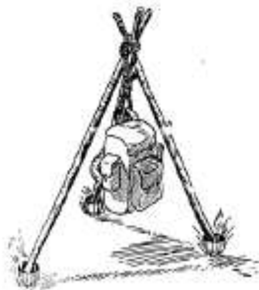
Ilustração 12 – Tripé calçado com latas cheias de água
