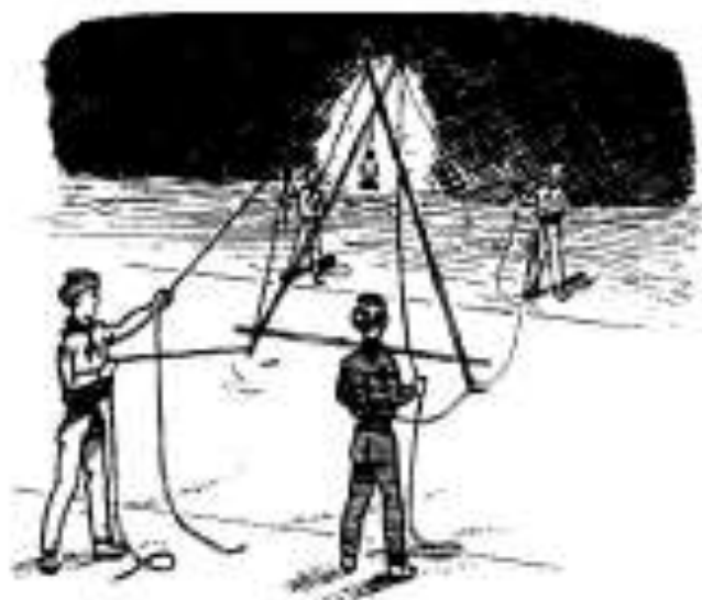
Ilustração 10 – Estrutura para elevação do lampião. (obs. os quatro cabos ficam estalados para estabilizar a estrutura)
