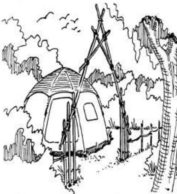
Ilustração 20 - Portal de construção simplista
