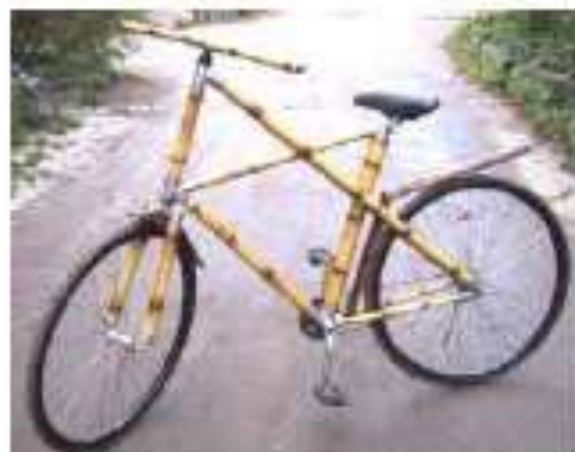
Ilustração 3 - Bicicleta construída na China com varas de bambu.
