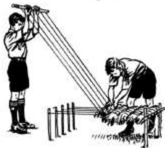
Ilustração 2 - Tear de campo para confecção de acolchoamento
