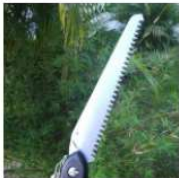
Ilustração 6 - Serrate utilizado para cortar bambu. Repare que é pequeno e com dentes finos.
