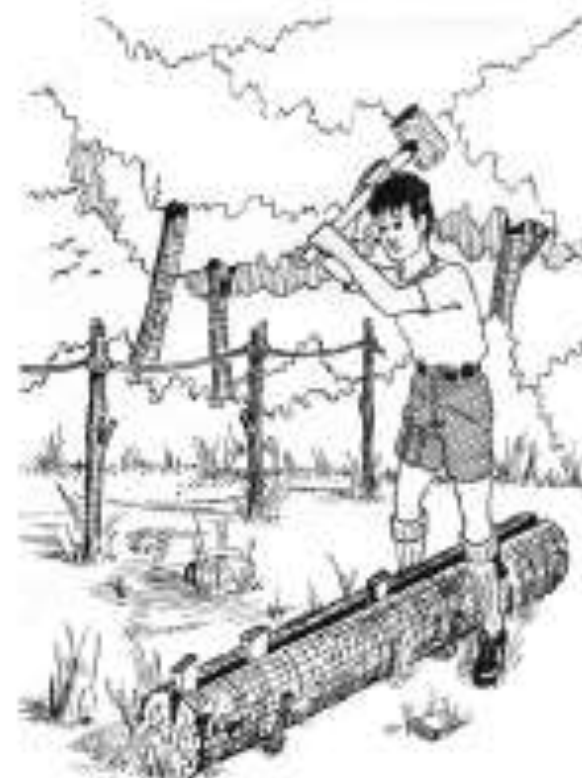
Ilustração 17 - Quando for rachar longitudinalmente uma tora, não use o machado mas sim cunhas de madeira
