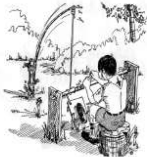
Ilustração 2 – Tomo mecânico de campo para pequenos trabalhos.
