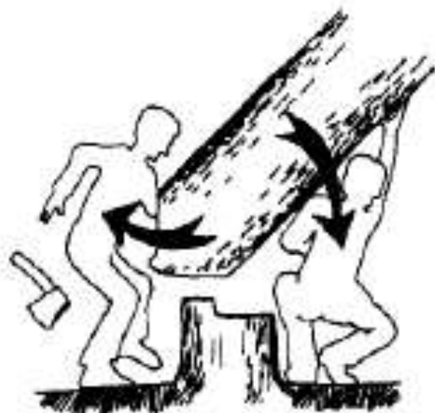
Ilustração 13 - Posições onde jamais devemos permanecer durante a queda de uma árvore
