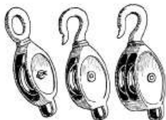
Ilustração 23 - Roldanas de diversos formatos, que podem ser sempre úteis para içamentos, transporte aéreo ou outras atividades que envolvam cabos e cordas
