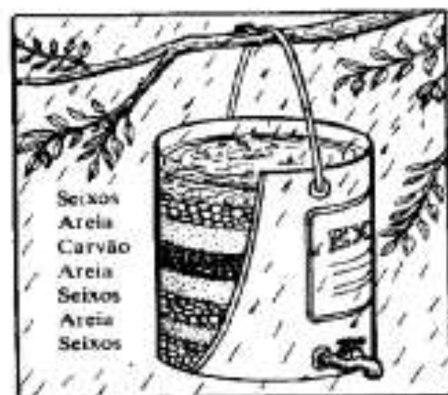
Ilustração 13 – Filtro de campo para limpeza de água.
