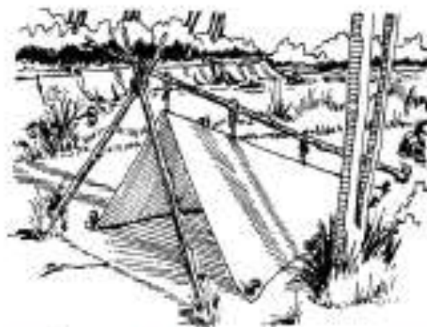
Ilustração 2 - Construção de abrigo simples com lona e que recebe o nome de "ratoeira"
