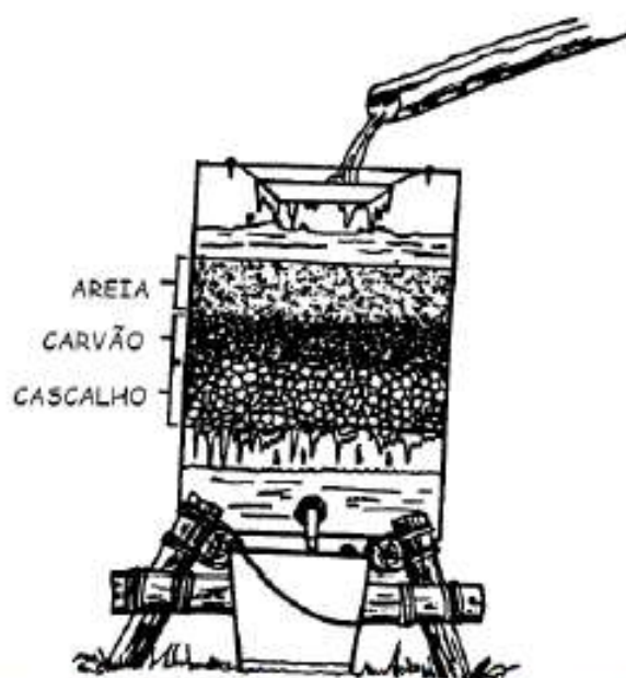
Ilustração 11 - Em condições de campo, você pode precisar filtrar a água e é simples construir um filtro.
