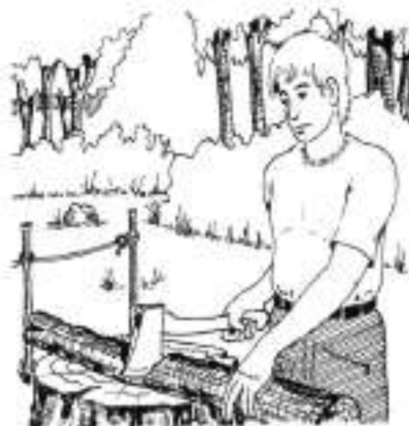
Ilustração 8 - Para o corte de peças pequenas, não se esqueça de apoiá-las
