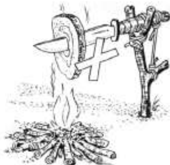
Ilustração 16 - Jamais use a sua faca como espeto de churrasco pois o calor estraga a têmpera da lâmina
