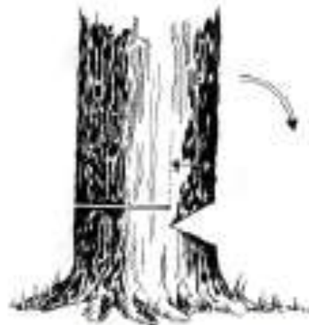
Ilustração 11 - Corte inicial para a derrubada de uma árvore
