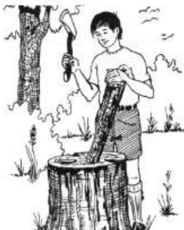
Ilustração 6 - Ao fazermos uso da machadinha, o objeto que estivermos cortando deverá estar sempre apoiado
