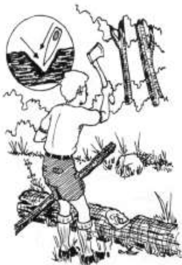
Ilustração 7 - Maneira correta de se cortar um tronco no chão
